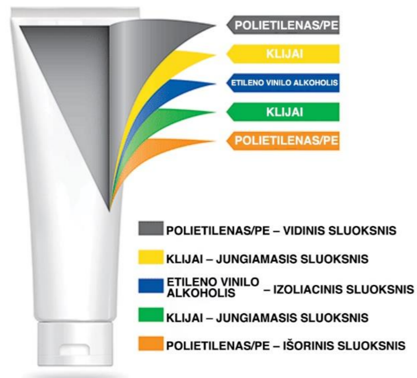
3 pav. 5 sluoksnių PE tūbelės konstrukcija. Aut. Lukas Matusevičius, 2022.
