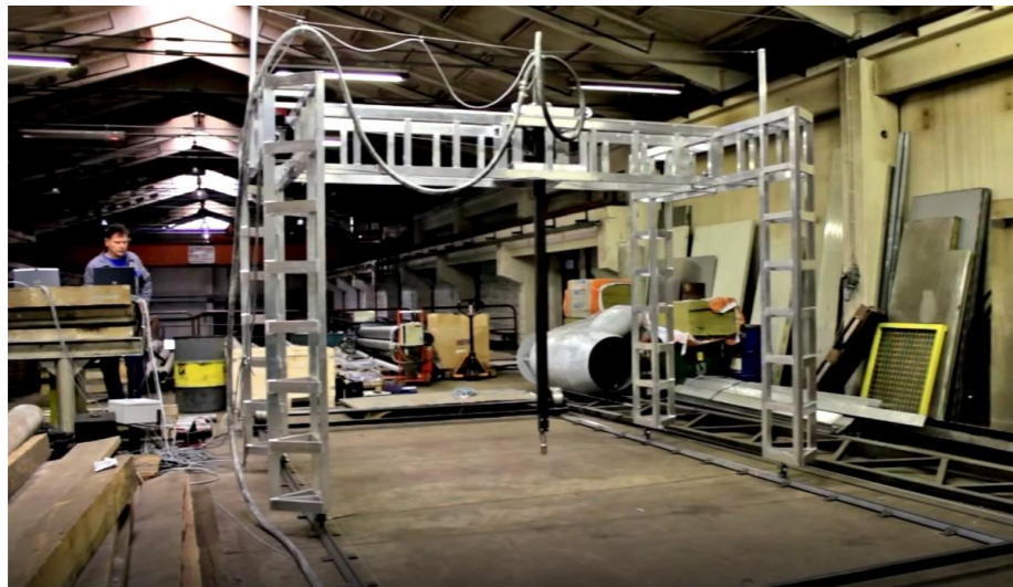
1 pav. Pramoninis 3D spausdintuvas „BetAbram P1“, skirtas pastatų statybai Šaltinis: https://www.3dprinter.com/top-10-largest-3d-printers-0535270/
