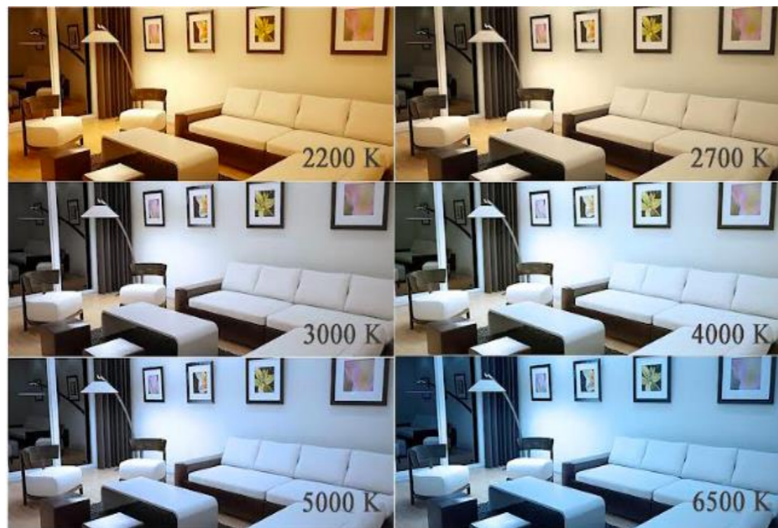
3 pav. Šviesos spalvos temperatūros įtaka interjero objektų spalvai, 2023 Sudaryta darbo autorės pagal šaltinį: https://www.lighting.philips.lt/consumer/led-lights/warm-led-light
